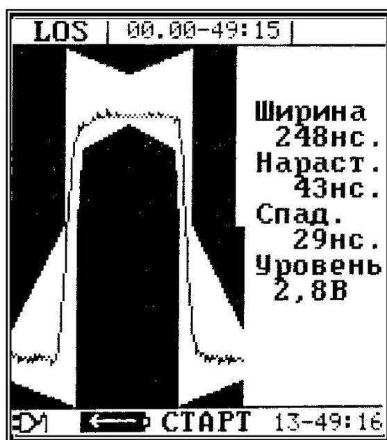
Рис.10.10.1. Вид экрана «Маска импульса»
