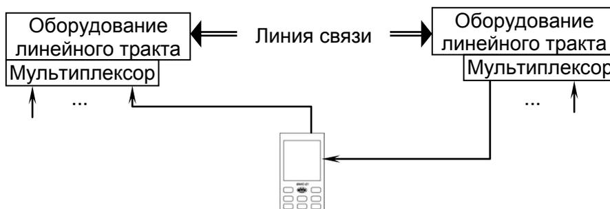
Рис. В1.1. Схема тестирования канала N×64 Кбит/с.
